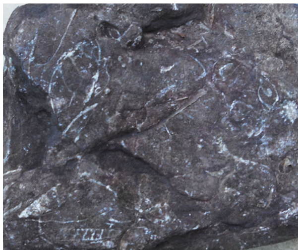
FIGURA 3. Caliza gris-rojiza a pardo oscuro, rica en conchas recristalizadas de los gasterópodos de diferentes especies (rasgos blanquecinos), embebidas en matriz arenosa polimíctica
